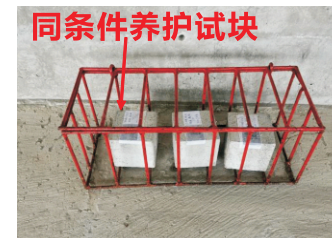
图2.16 现场留置现浇板同条件试块
