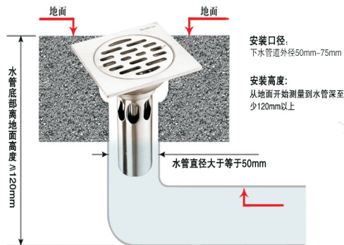
图10.5 地漏安装样板
