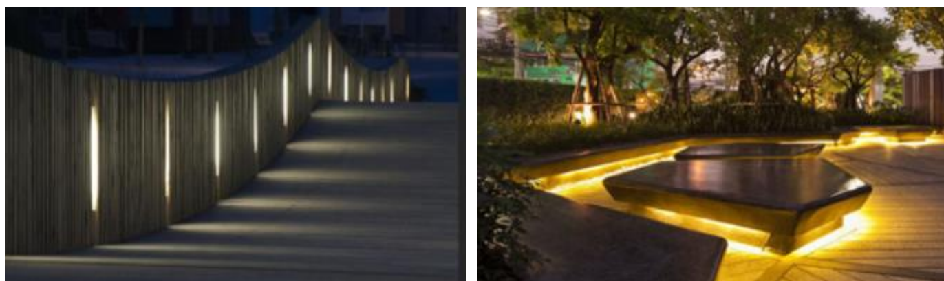
栏杆立柱内侧条形灯
