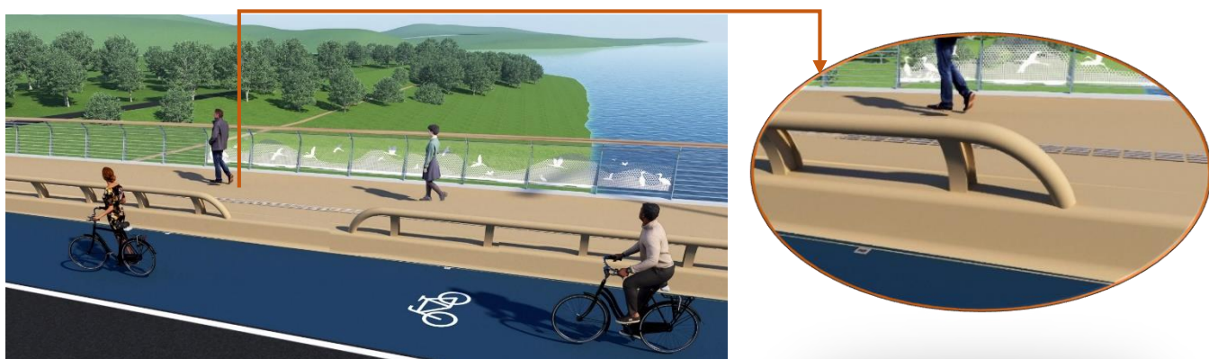
防撞栏杆收口处理
