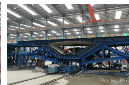
工厂预制梁段示意
