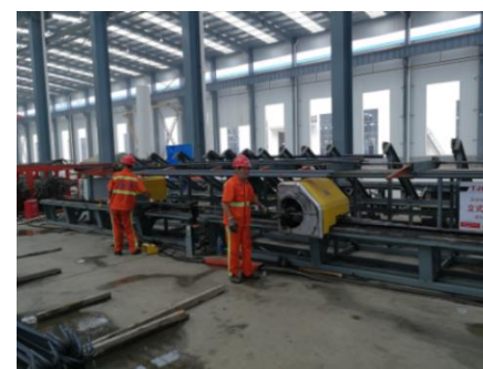
工厂数控机床 钢筋加工示意
