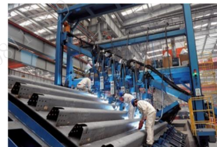
钢箱梁工厂加工示意
