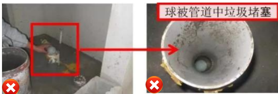
图 5.6.1-3 通球试验通球堵塞
