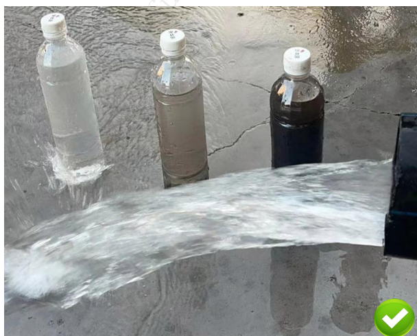
图 5.6.2-1 管道冲洗出水清澈透明，与入口色泽一致
